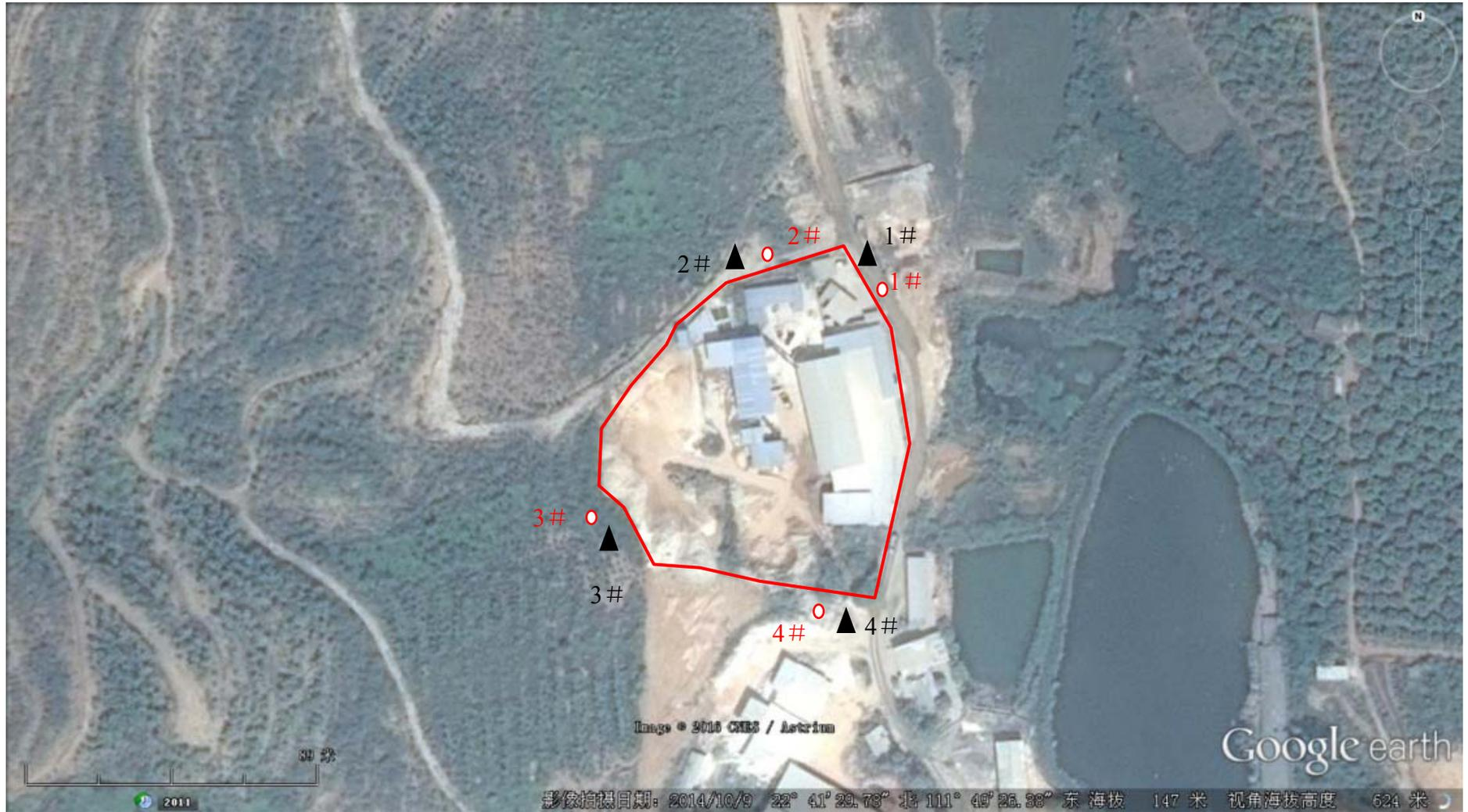
图 2.2-2 现有项目厂区无组织废气及噪声监测布点图
